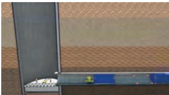
รูปที่ 5 การสอดร้อยท่อเหล็กภายใน
